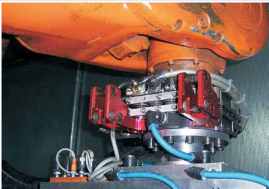
Использование на зажимном устройстве для литых деталей Application at a clamping device of cast pieces
