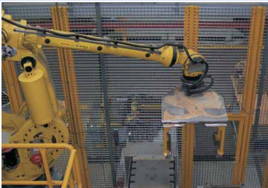
Перемещение песчаных литейных стержней Handling of sand cores
