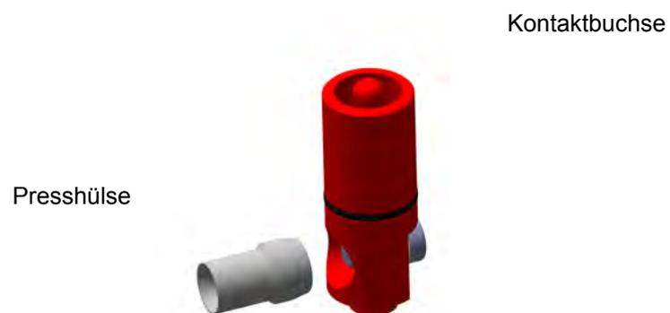
Die Presshülse in den Kontaktstift oder -buchse stecken und mittels einer Schraube festdrehen.
