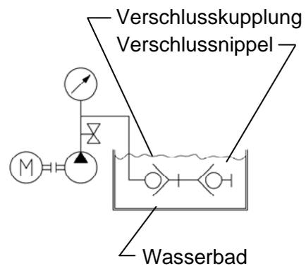
Prüfung 2: Verschlusskupplung entkuppelt
