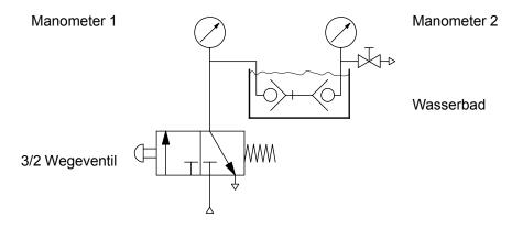
Druckluft max. 2 bar
